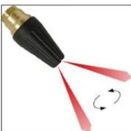
**Buse Turbo** : Pulvérise l'eau par un orifice à zéro degré. Avec son embout pivotant, le jet d'eau sort à différents angles, tout en effectuant une rotation. L'effet du jet d'eau permet à l'opérateur de couvrir une plus grande surface. Son usage est idéal pour déloger la boue durcie, la peinture qui s'écale, nettoyer le ciment et plusieurs autres applications où une buse à jet plat a plus de difficulté à nettoyer.
